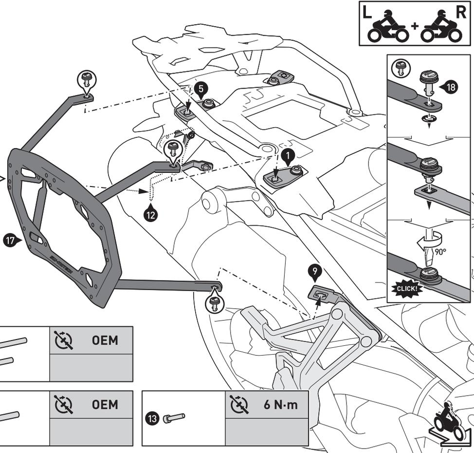
Verbinden Sie die Koffertrger (17) mit den Schnellverschlssen (18) an dem Querverbin-der (12) und den Befestigungslaschen (1), (5) und (9), wie in der Zeichnung gezeigt.
