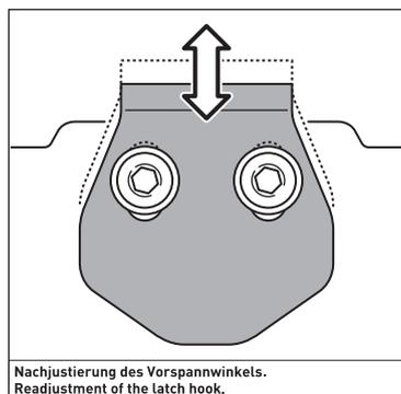
Anschließend den Spannverschluss des TRAX ION Topcase wie gezeigt am Vorspannwinkel einhängen und umklappen.
